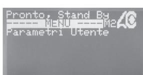
Zugriff erhält man durch Eingabe des Passworts "0000123000". Hier kann der Unterdruck und die Sprache geändert werden, der erzeugte Code abgelesen und auf das Menü Aktivierung zugegriffen werden.
