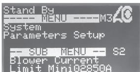
Zugriff erhält man durch Eingabe des Passworts "0000456000". Es können die Ausschaltverzögerung und andere technische Parameter geändert werden.
