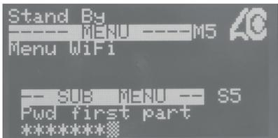
Das Menü M5-S5 ist der Ort, an dem mit den Pfeilen das Passwort des WiFi-Routers eingefügt und eingegeben wird.
