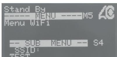
Im Menü WI-FI zum Kontrollieren in SSID M5 S4 des angewählten Netzes.
