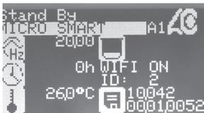
Es werden bestimmte Parameter wie die Betriebsfrequenz, die Aktivierungszeit der Absaugmaschine, die Temperatur, der Amalgambehälter (falls vorhanden) und die Software-Revision des Systems angezeigt.
