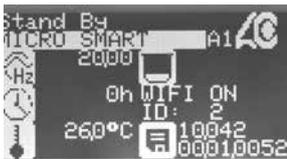
Es werden einige Parameter wie Betriebsfrequenz, Aktivierungszeit der Saugmaschine, Temperatur, Amalgambehälter (falls vorhanden) und Revision der Systemsoftware angezeigt.
