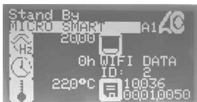
Wenn die Kommunikation mit einem PC in Betrieb ist, zeigt die Anzeige WI-FI DATA.
