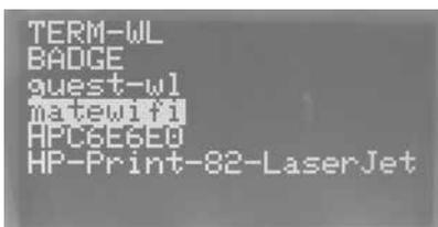
Nach erfolgter Suche werden alle in der Nähe des Geräts verfügbaren WiFi-Netze angezeigt.
