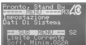
Grenzwert Stromaufnahme Saugmotor für min. Unterdruck (nur Micro-Smart und Micro-Smart Cube)
