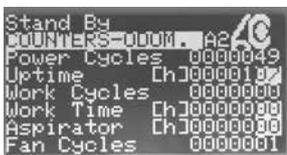
Es wird angezeigt: wie oft die Maschine eingeschaltet wurde, die Gesamtzahl der Einschaltstunden, die Anzahl der Aktivierungen der Saugmaschine, die effektiven Gebrauchsstunden der Saugmaschine, die Arbeitsstunden im Verhältnis zur Frequenz und die Anzahl der Aktivierungen des Lüfters.
